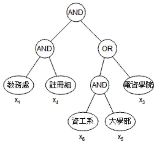
以下請撰寫一個 BFormula 的類別來代表右圖控管資料存取的運算式  $f(\cdot) = (x_1 \text{ AND } x_4) \text{ AND } ((x_6 \text{ AND } x_5) \text{ OR } x_3)$ ，另外也請撰寫一個 Attribute 的類別來代表某一使用者具有的屬性集合  $A = \{x_1, x_4, x_6, x_5\}$ ，亦即  $x_1=true, x_4=true, x_6=true, x_5=true$ ，其它不在 A 中的屬性皆為 false，以此例而言  $f(A)$  為 true。
