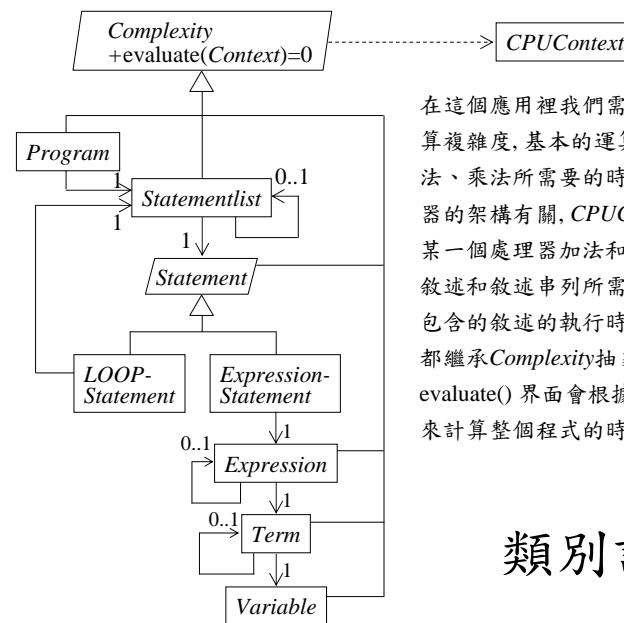
在這個應用裡我們需要估計一個程式的運算複雜度，基本的運算複雜度和每一個加法、乘法所需要的時間有關係，這些和處理器的架構有關，*CPUContext* 裡面可以記錄某一個處理器加法和乘法需要的時間，迴圈敘述和敘述串列所需要的時間基本上是所包含的敘述的執行時間的總和，所有的類別都繼承*Complexity*抽象類別，其中的 evaluate() 界面會根據傳入的 *CPUContext* 來計算整個程式的時間複雜度。
