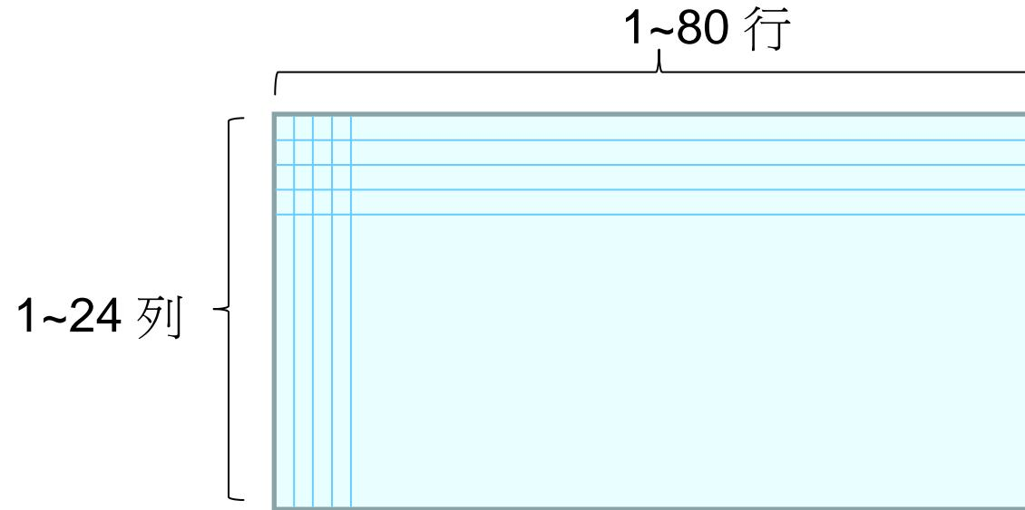
10. 如上圖文字模式視窗裡一般可以顯示  $24 \times 80$  個字元 (可以手動設定其它大小)，`stdio` 函式庫運作時有一個目前游標的位置，列印時由游標位置一個字元一個字元輸出，游標位置就移動到最後一個輸出字元的下一個位置，`stdio` 函式庫並沒有提供操作游標位置的工具函式，一切輸出都按照順序執行。像前面所談到在這個遊戲的界面裡，有一個迴圈不斷地詢問使用者輸入，然後印出整個遊戲畫面，螢幕會不斷地向上捲動，對於玩家來說會造成很大的干擾，沒有辦法輕易地掌握盤面的變化。所以基本上希望輸出的界面裡所有的元素位置都是固定的，要達到這個效果，就需要 **gotoxy(行, 列)** 這個移動游標位置的函式。呼叫函式 `gotoxy(x, y)` 會把游標移動到第  $x$  列，第  $y$  行的位置，接下來的 `printf`, `putchar..` 等等輸出就會由該點繼續下去
